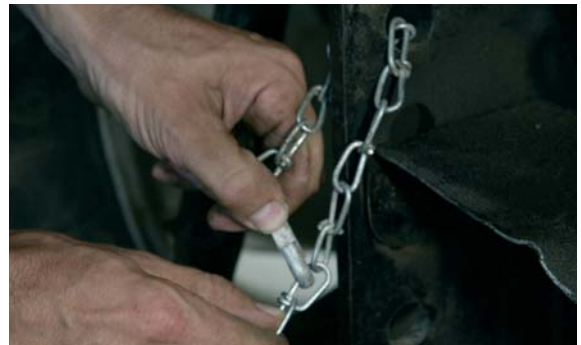
Voor het loskoppelen van de tussenas maak je eerst het kettinkje los
