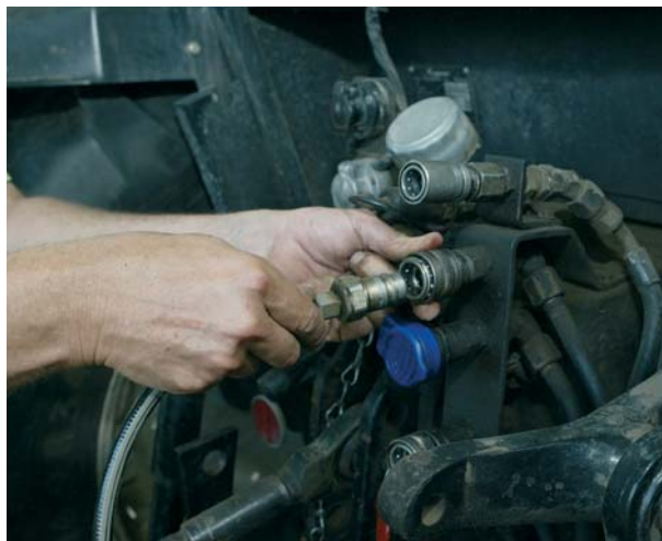
Sluit de hydrauliekslangen aan
