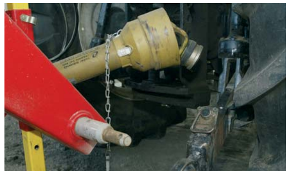
Maak de tussenas vast aan het werktuig, zodat die niet vuil wordt
