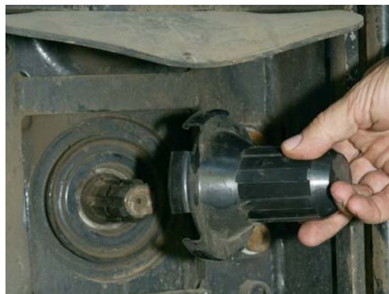
Aanbrengen beschermkap of beschermdop
