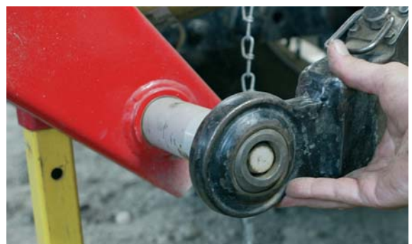
Ontkoppel de trekstangen
